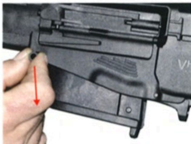
Slika 19: skidanje osovine nosača spremnika
