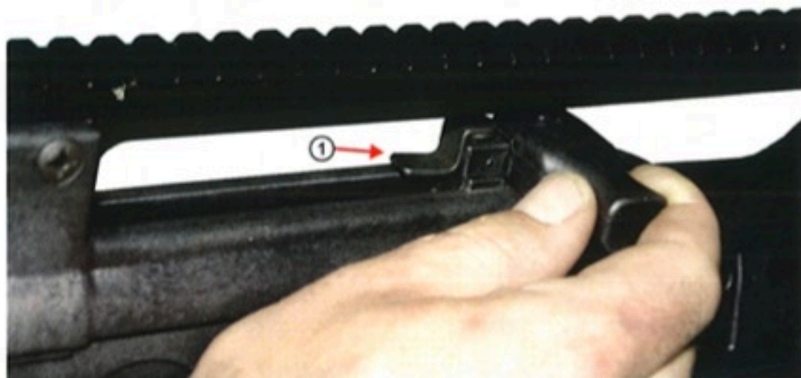
Slika 55: Zatik za zapinjanje kao pomoć pri zabravljivanju
