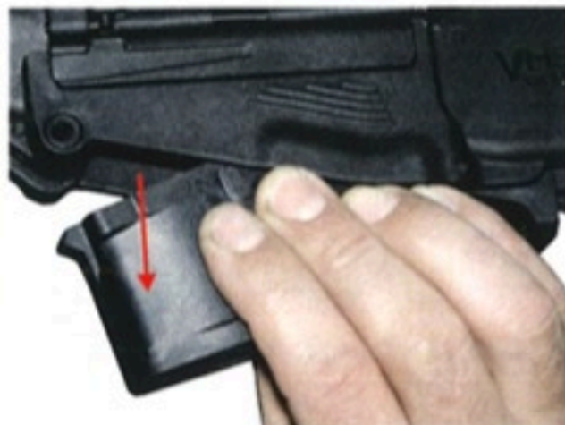
Sl. 20: Skidanje nosača spremnika
