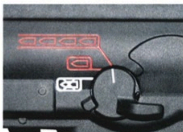
Slika 10: Kočnica- položaj „automatska paljba“ (rafalno)
