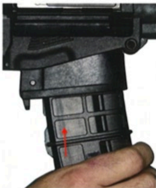
Slika 53: Umetanje spremnika u pušku
