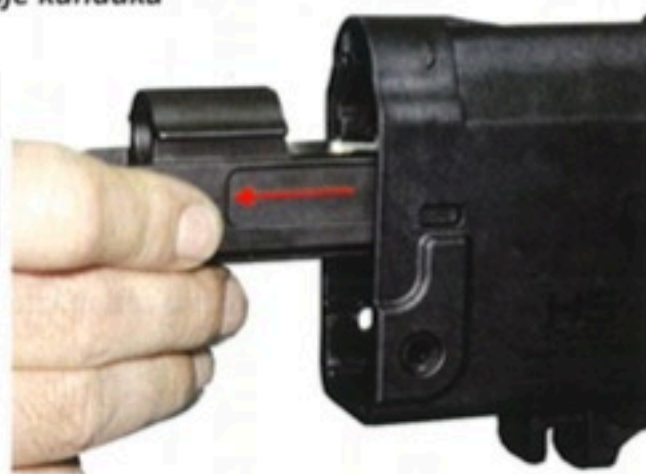
Slika 29: Vađenje sklopa nosača zatvarača
