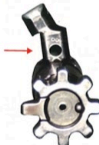
Slika 42: Zakretni dio za izbacivanje u desno
