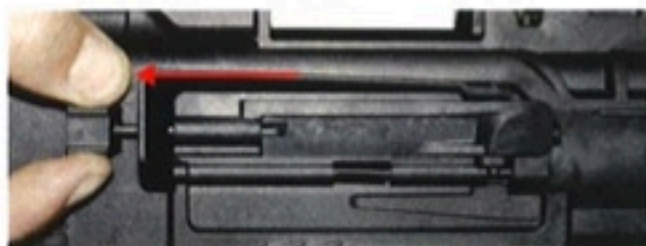
Slika 46: Vađenje blokade poklopca,
