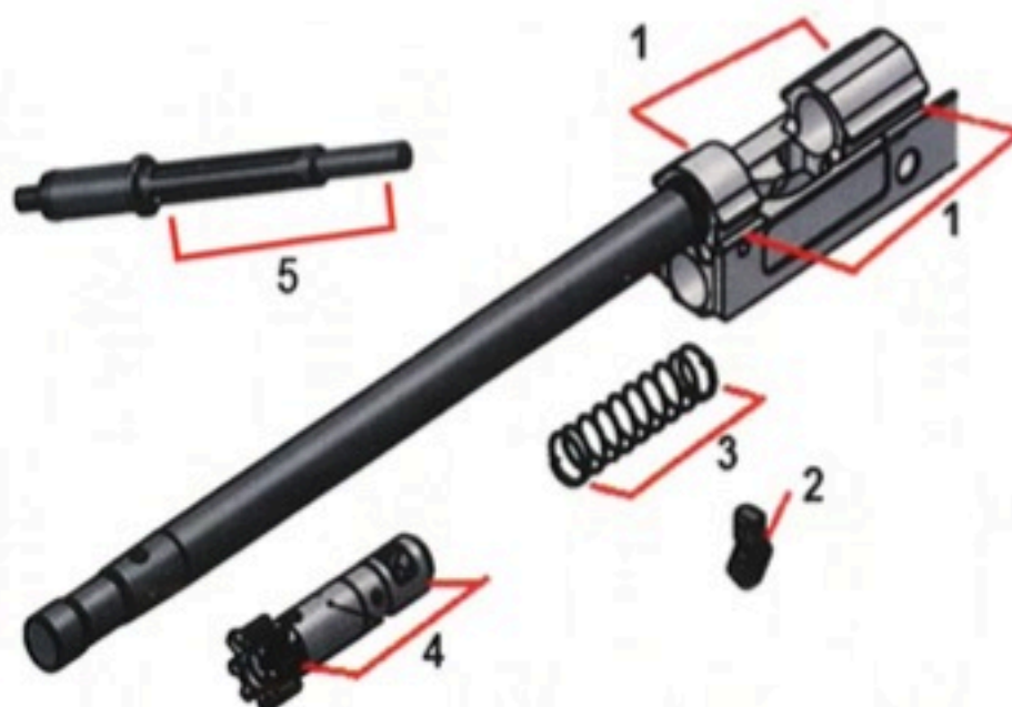
Slika 68: Mjesta podmazivanja vitalnih dijelova
