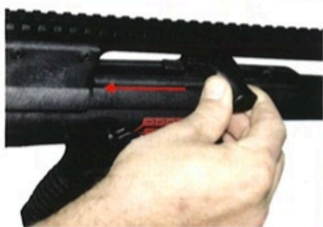
Slika 28: Povlačenje zatvarača u zadnji položaj
