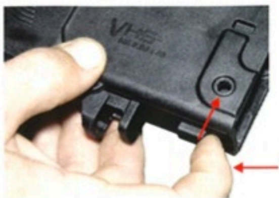
Slika 30: Potiskivanje utvrđivača mehanizma
