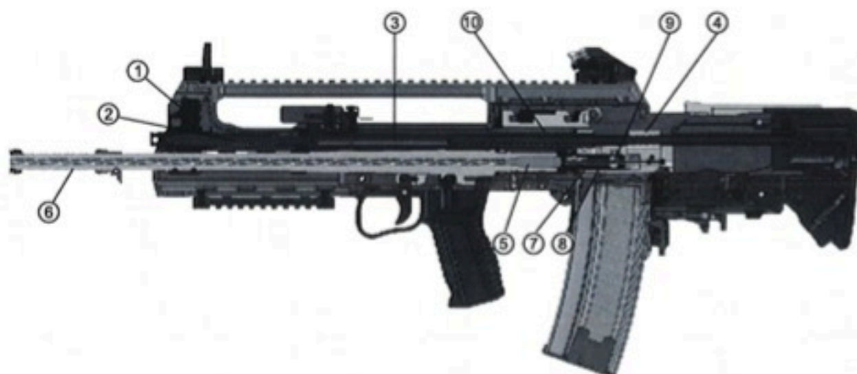
Slika 4: Presjek puške VHS-D2, lijeva strana - položaj „zabavljeno“
