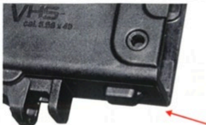
Slika 44: Ispravno osigurani mehanizam
