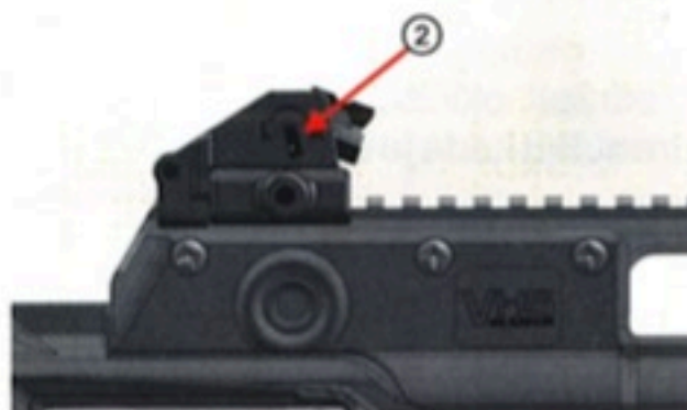
Slika 57: Vijak za podešavanje pogodaka po pravcu
