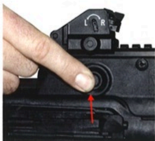
Slika 36: Osigurač rama za nošenje
