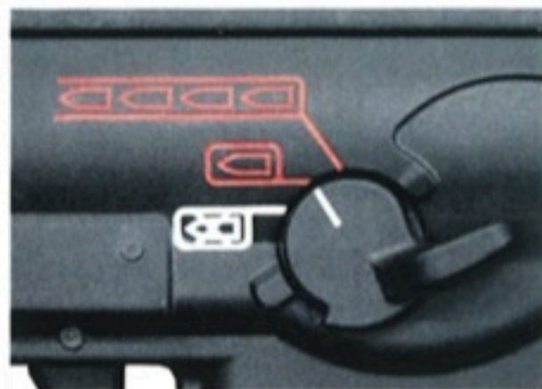
Slika 9: Kočnica – položaj „pojedinačno“
